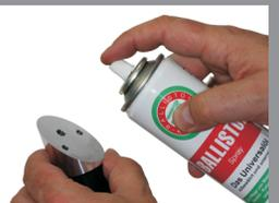
Vor dem Zusammenbau die Bohrungen der Zylinderstifte mit einem feinen säurefreien Maschinenöl (z.B. Ballistol, WD40, USTANOL) benetzen.
