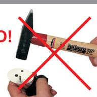
**Niemals die Zylinderstifte mit einem Hammer oder einem ähnlichen Werkzeug einschlagen. Der Schlüssel kann dadurch beschädigt werden.**
