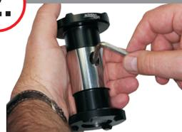
Die zentrale Innensechskantschraube mit einem 5mm Innensechskantschlüssel lösen und herausnehmen.
