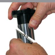
Die Schlüsselteile in Laufrichtung der Zylinderstifte ohne Kraftaufwand zusammenschieben.
