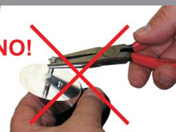
**Die Zylinderstifte niemals mit einer Zange entfernen. Der Schlüssel kann dadurch beschädigt werden!**
