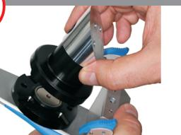
Das Schlüsseloberteil, welches an der Bohrung auf der Stirnseite zu identifizieren ist, in das Artikulator-Oberteil einsetzen.
