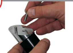
Die Zylinderstifte vorsichtig von Hand entfernen. Ein leichtes Hin- und Herdrehen der Zylinderstifte reduziert den Widerstand beim Herausziehen.
