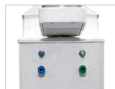
Schnellkupplung für Luft und Wasser, Fremdgerät
