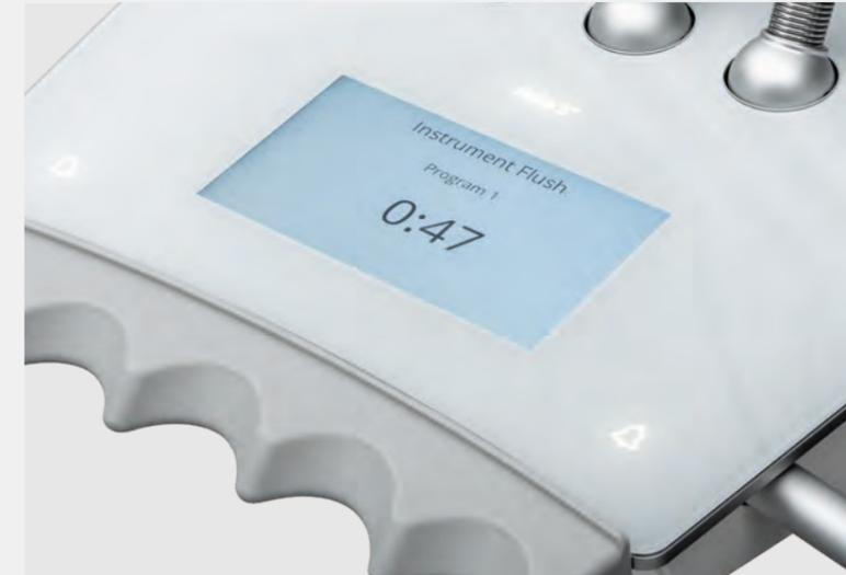
sigkeit mittels Unterdruck durchgespült wird und so schnell für einen neuen Patienten bereitsteht. Das Display auf dem Instrumententisch zeigt an, ob der Vorgang korrekt abgeschlossen wurde. Gleichzeitig haben Sie die Möglichkeit, den Prozess über Heka S\* Connect zu dokumentieren.
