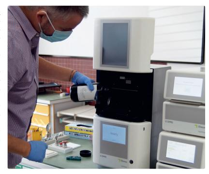
Einfache, saubere Befüllung des 3D-Druckers DMG 3Delite durch portionierte Materialmengen
