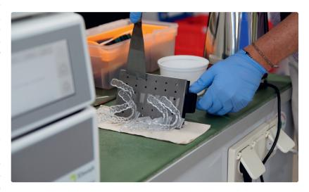
Die Schienen werden von der Trägerplatte entfernt, gesäubert und endpolymerisiert.
